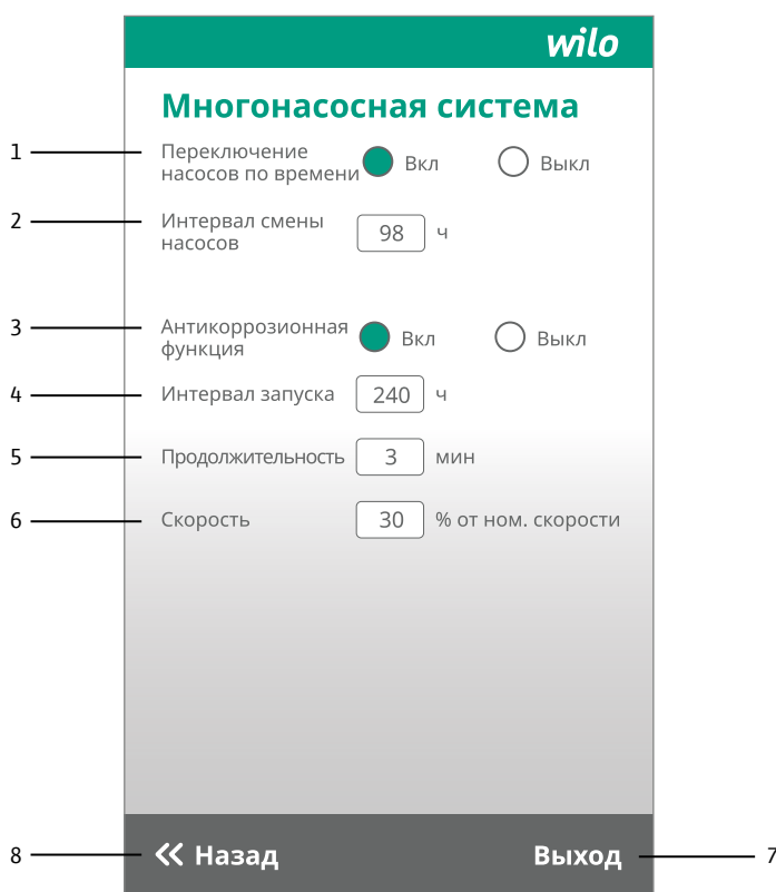
Рис. 5.1.12. Настройка системы из нескольких насосов
